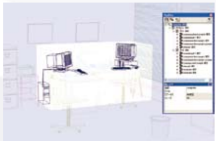
3D モデルの中でアセンブリオブジェクトを編集 「コンピュータ」アセンブリオブジェクトを編集モードにして、個々の「パソコン」の配置を調整
